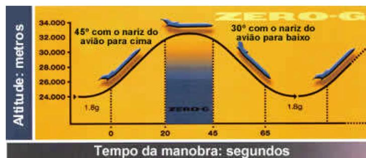
Figura 1.- Rota de voo parabólico.
